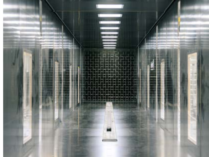
Der 30 Meter lange Windkanal mit seinem neun Quadratmeter großen aktiven Gitter ist das wissenschaftliche Herzstück des Oldenburger WindLabs.
