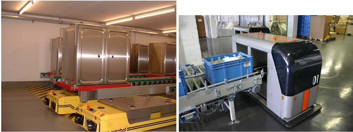
(a) FTF als Unterfahrschlepper (Quelle: Joerg Hammes) (b) FTF mit Gurtförderern (Quelle: Thomas Albrecht, Fa. FROG)
