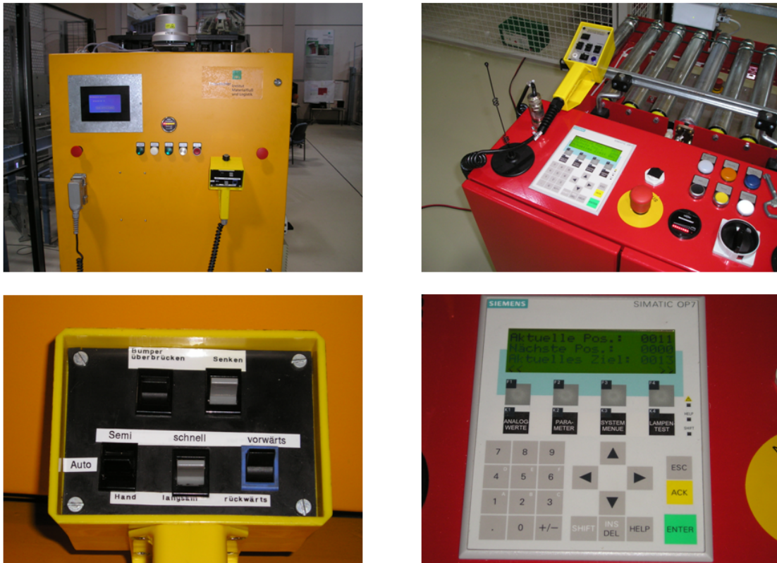
Abbildung 2.8: FTF Bedienelemente (Quelle: Thomas Albrecht, Fraunhofer IML, Dortmund 10 )
