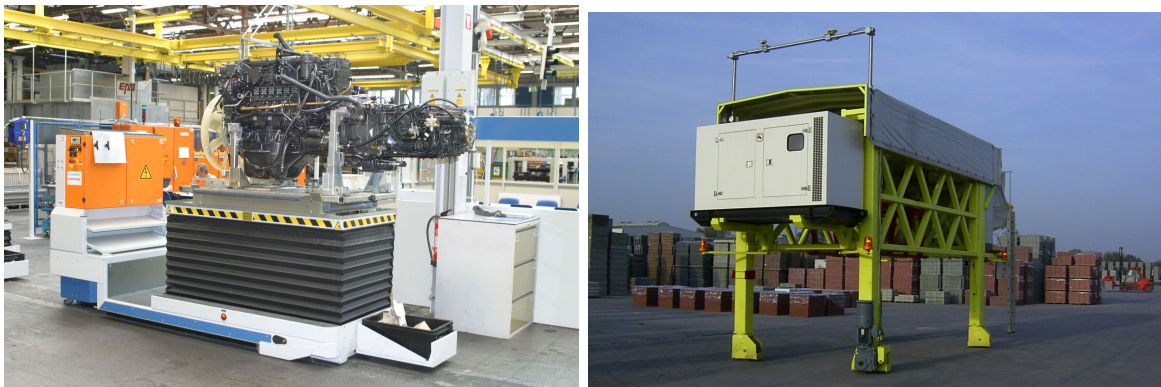
(a) FTF als mobile Montageplattform (Quelle: Fa. Bleichert) (b) Outdoor FTF zum Transport von Betonsteinen (Quelle: Betonsteinwerk Lintel)
