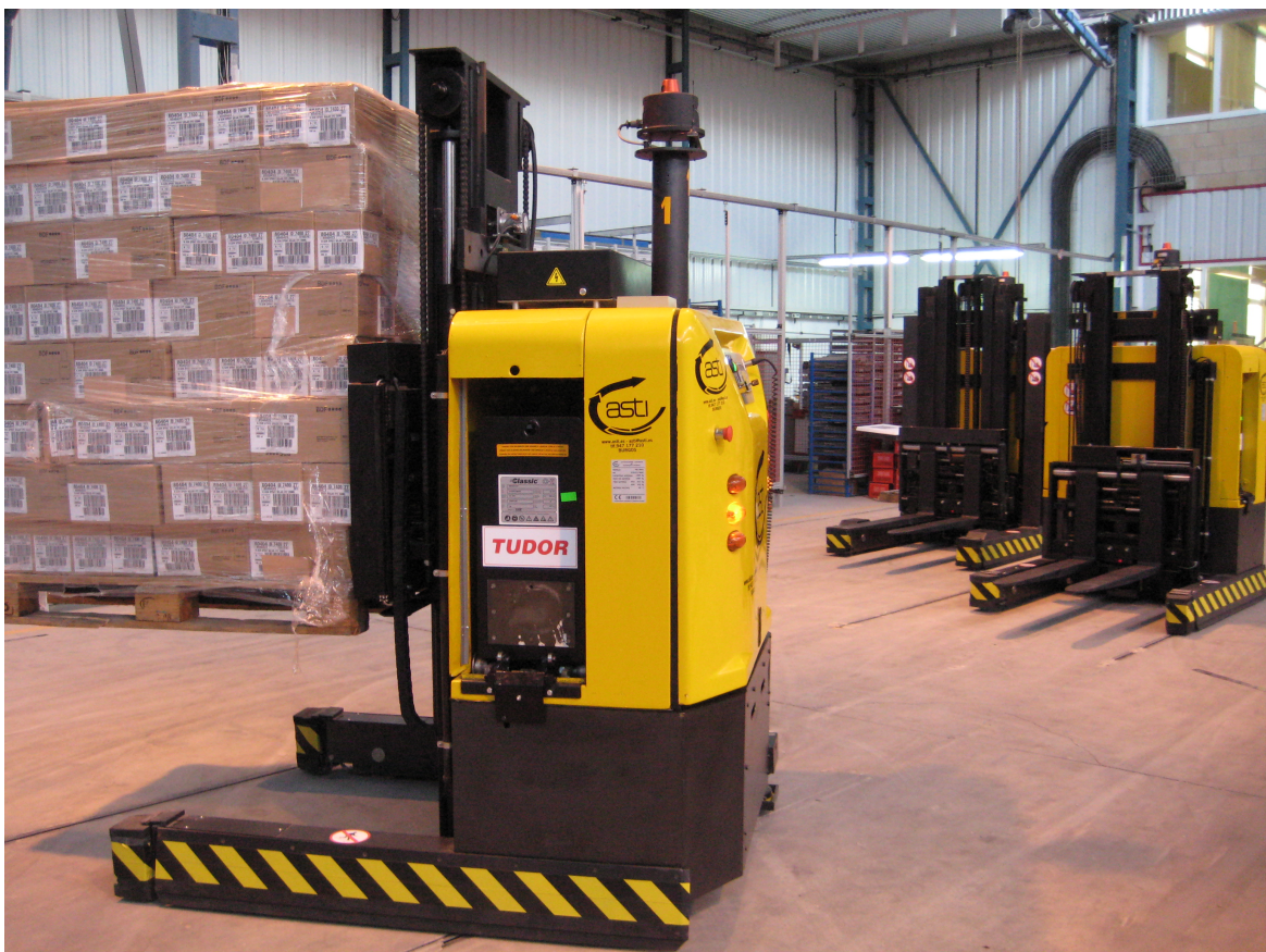
Abbildung 2.1: Ein Fahrerloses Transportfahrzeug (Quelle: Carmenter 2 )
