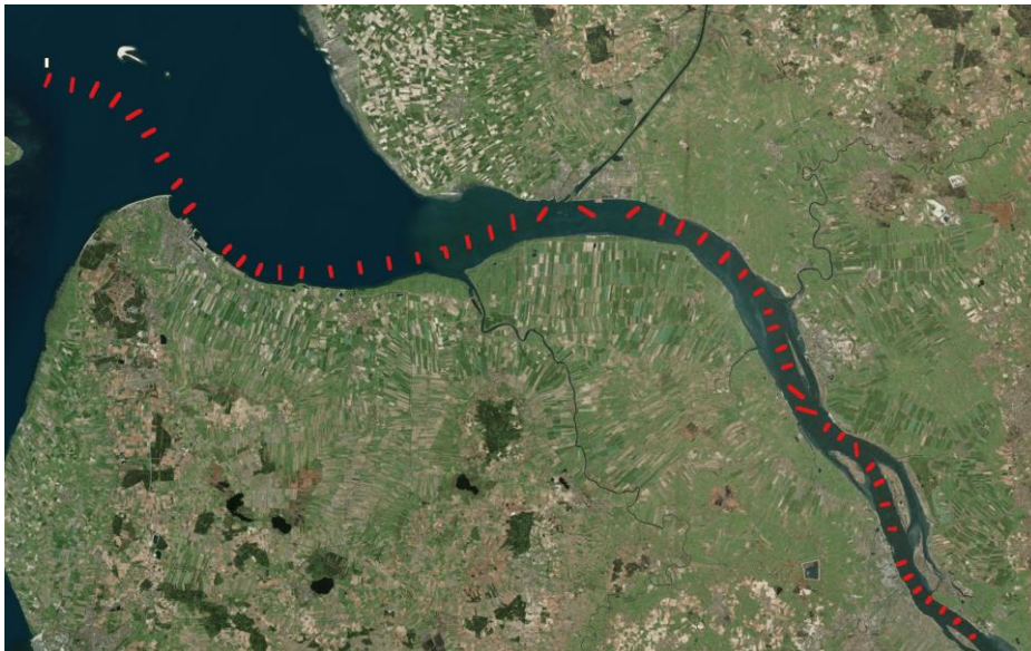
Abbildung 55: Historische Schiffsbahnen durch das Elbefahrwasser, die als Sequenz von Übergangspunkten modelliert sind.
