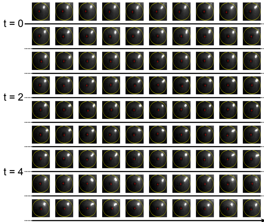
Abbildung 5.27: Einzelbildauschnitte einer Videosequenz von 6 Sekunden. Die Umrandung des Augapfels (gelber Kreis) wird durch den Starburst Algorithmus erkannt und die Pupille (rotes Kreuz) getrackt.
