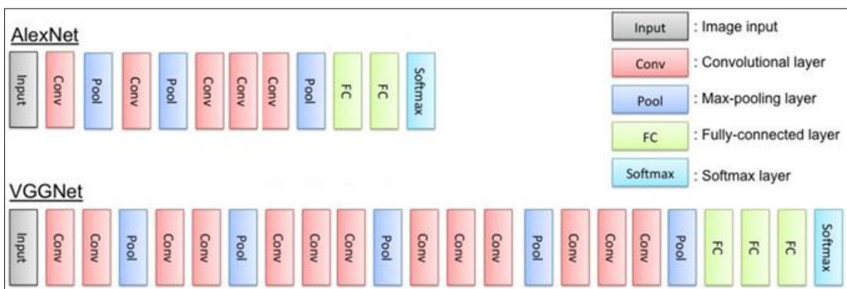
Abbildung 3-5: Architektur der tiefen neuronalen Netze AlexNet [58] (oben) und VGG-16 [59] (unten) (Bild aus [63] angepasst)
