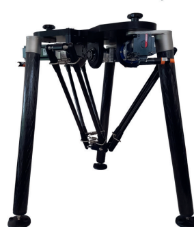
Parallelkinematik: Labor-Prüfstand am Institut für Mechatronische Systeme
